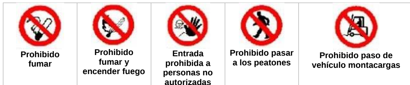
Fig.3. Señales de prohibición (peligro)
